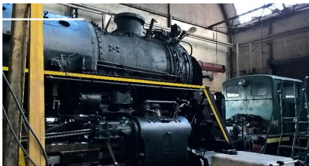
Dépose de l'habillage de la chaudière.
